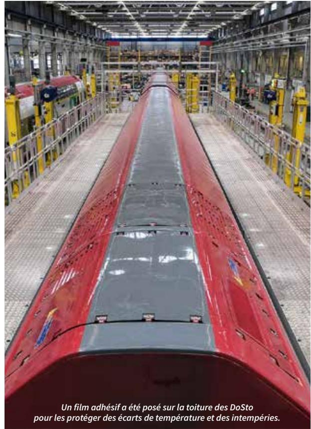
*Un film adhésif a été posé sur la toiture des DoSto pour les protéger des écarts de température et des intempéries.*
