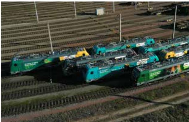
Hybrides, les « TRAXX MS3 » peuvent circuler en mode électrique sur les tronçons non électrifiés, en particulier sur les sites des terminaux intermodaux.
